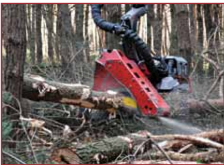
Le rondin ébranché est tronçonné
