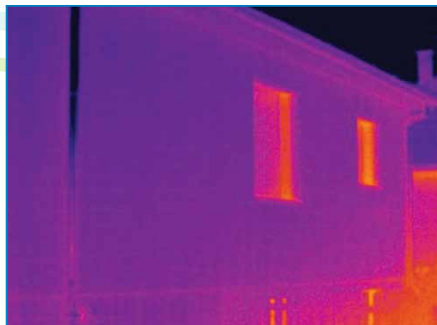
Exemple de maison avec isolation extérieure ; pas de pont thermique au niveau des dalles.
