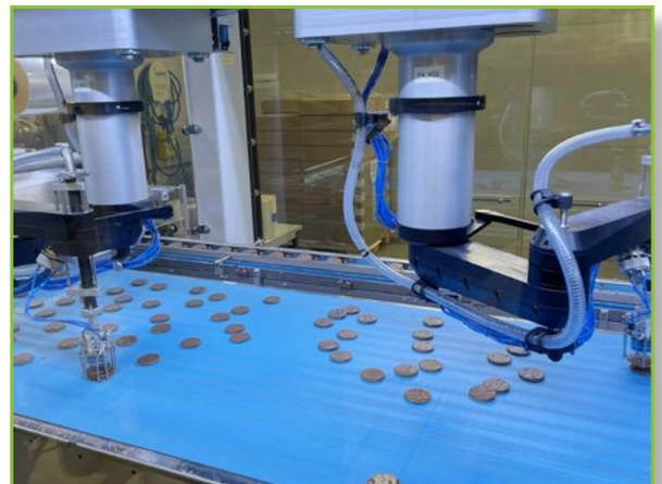
Des moyens de production ultra-modernes : ici un robot d'ensachage.
